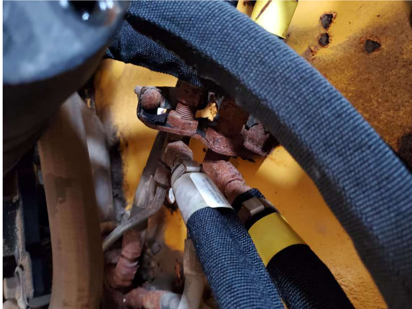
C:\Users\lccosgrove\Documents\2022 Budget pictures\323 Mini track Loader\Line corrosion 2.jpg
