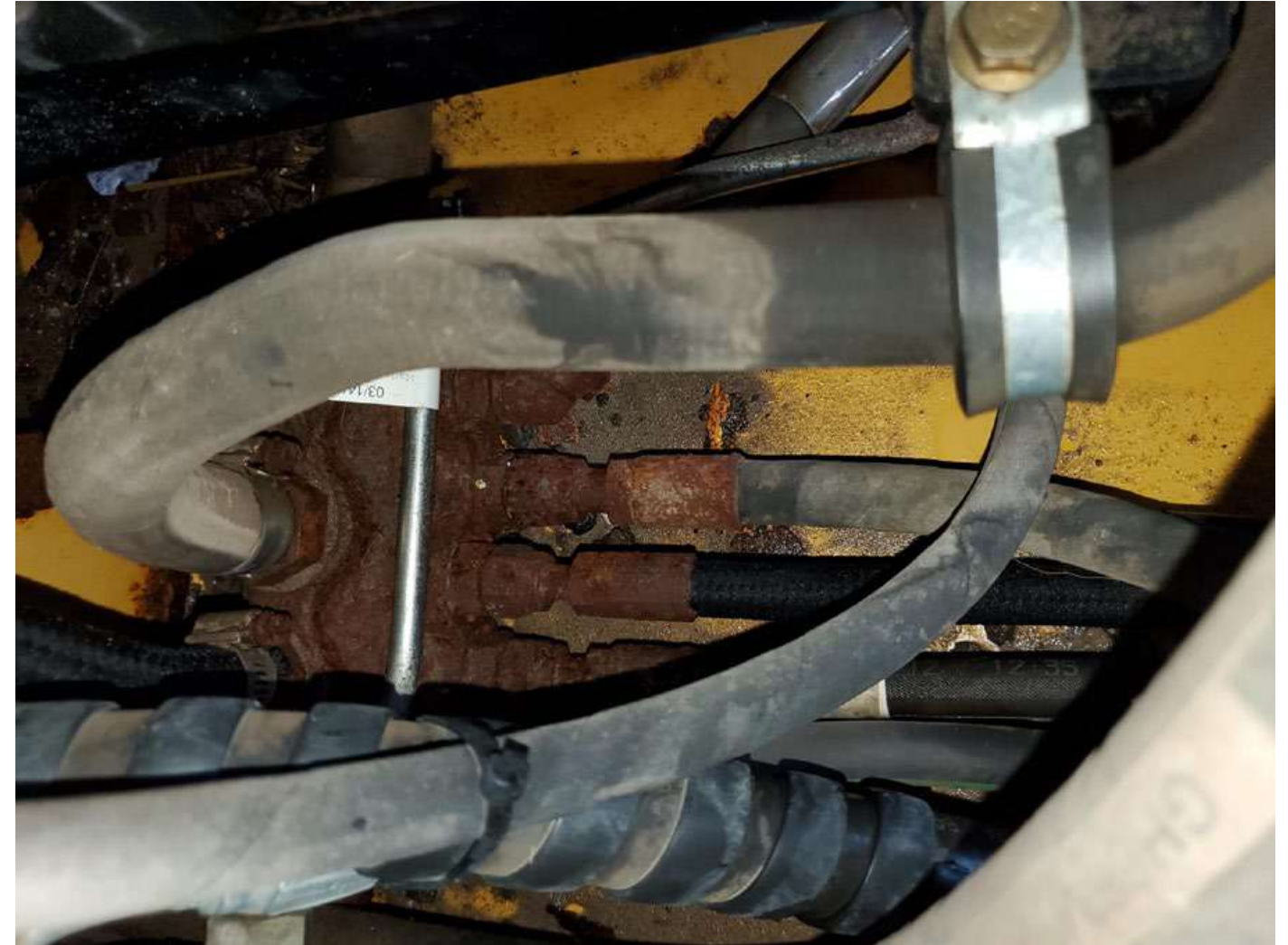
C:\Users\ccosgrove\Documents\2022 Budget pictures\323 Mini track Loader\Line corrosion.jpg
